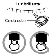
La electricidad generada por la celda solar del reloj se almacena en una pila recargable. La pila se podría descargar si deja o lleva puesto el reloj sin exponerlo a la luz. En lo posible, asegúrese de mantener el reloj expuesto a la luz.
